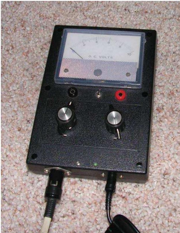
Obr. 18. Indikátor s TLV2224
