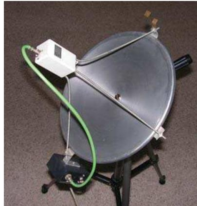
Obr. 14. Anténa a LNB
