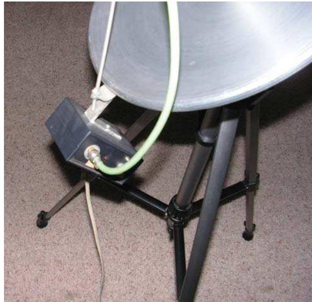
Obr. 19. Mf blok s klíčováním (viz schéma na obr. 11)
